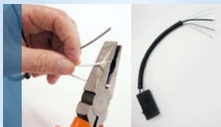
2. Descasque a extremidade dos fios.
