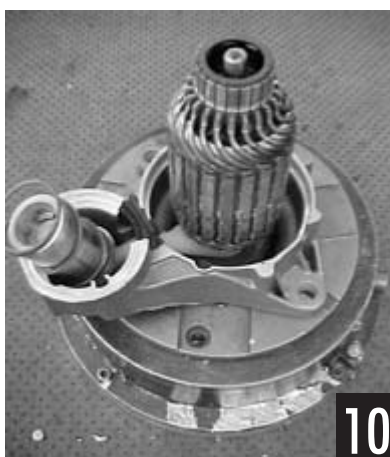
Retirar os 2 parafusos para sacar o mancal traseiro
