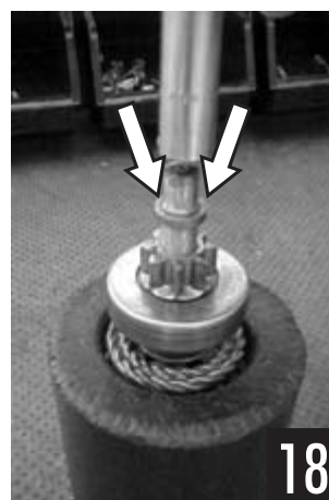
Apoiar um tubo no anel, batendo com martelo no sentido indicado para destravá-lo
